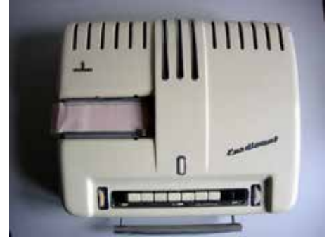
Primo apparecchio "portatile" a valvole (pesa 15 kg circa) della serie Cardiomat Siemens, 1958
